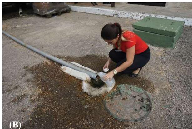
Figura 2.-Colecta del agua de rechazo de los equipos de ósmosis inversa del CIM (Tomado de Bejerano, 2017).
