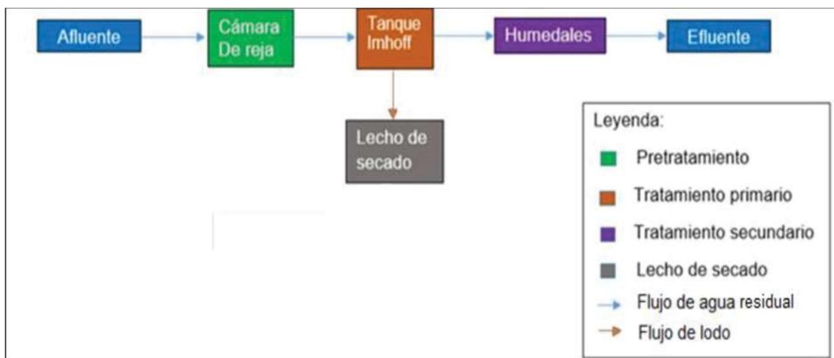
**Figura 7.-** Esquema de la PTAR Sierra Maestra (Figura extraída del documento original).
