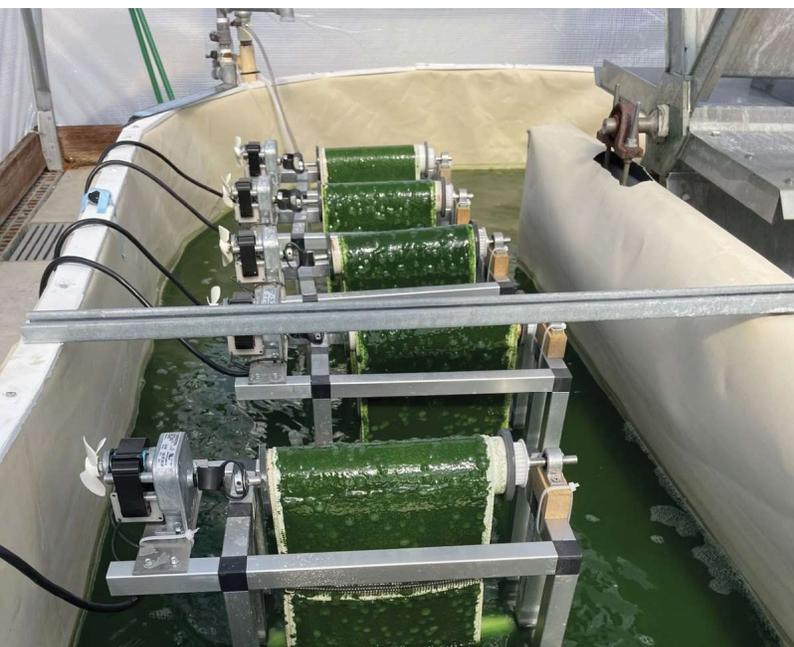
Se utiliza un reactor de biopelícula de algas giratorio (RAB) a escala de laboratorio para cultivar algas.
